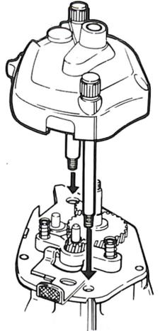
**6** さらに、メインギヤ支柱を、ライトサイドプレートの穴に通し、ライトサイドプレートとフレームを合致させます。
