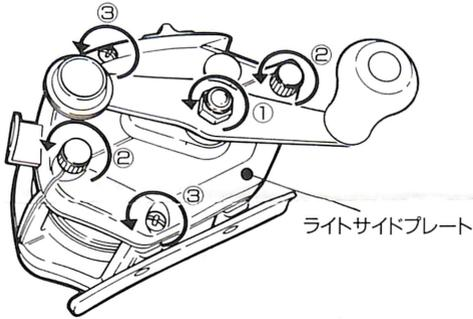
**2** 組立てる場合、分解と逆の手順で進めますが、以下の点に注意しながら組立てて下さい。アンチリバースポール①を、指で押し、ピンを支点に、ツメの部分を上②のメインギヤの裏にあるラチェットに、かみ合うようにメインギヤをはめ込みます。
