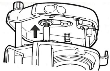
**7** ライトサイドプレートのボルト2個と、ツマミ2個を締め、ハンドルをナットで固定して組立は終了です。
