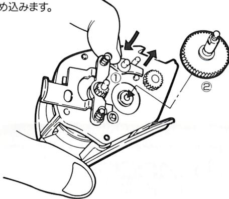
**3** クラッチヨークプレートを、フレームのストッパー部分まで引き出します。
