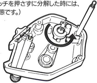
**5** 前記、2.3.4.の状態を保ちながら、抜き取られたシャフト及び、ライトサイドプレートをはめ込みます。(この時、ライトサイドプレートを真上から、はめ込むようにし、ギヤ等が落ちないように注意して下さい。)
